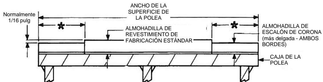
Figura 2: Almohadilla de revestimiento de escalón de corona
