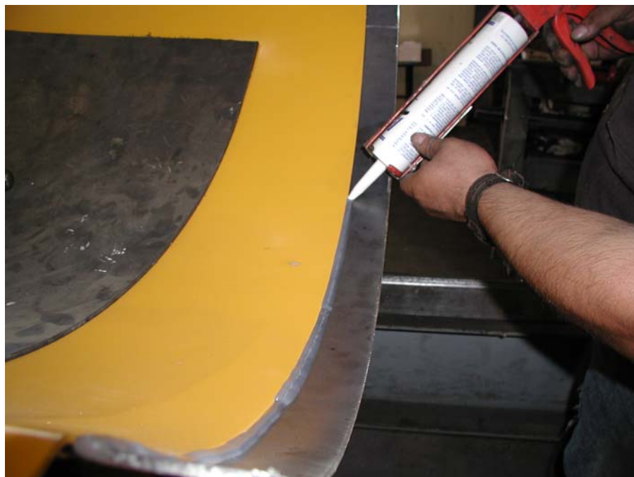
Paso 4: Aplique silicona a lo largo de la junta.
