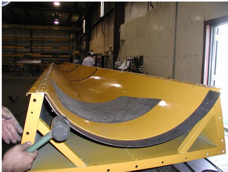
Paso 2: Centre la banda de alineación a lo largo de la junta.
