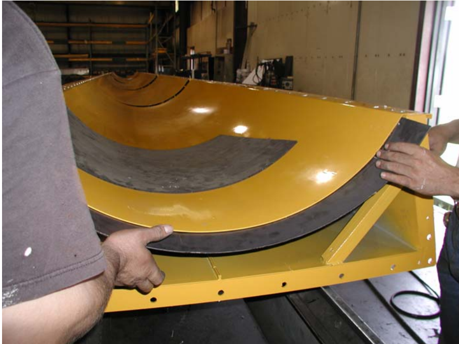
Paso 1: Inserte la banda de alineación en la conexión de la brida.
