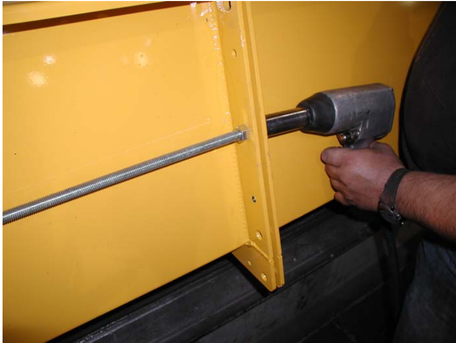
Paso 11: Termine de apretar las varillas de conexión en ambos lados.
