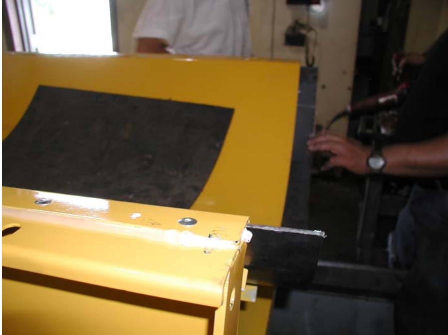
Paso 3: La banda de alineación ha sido centrada a lo largo de la junta.
