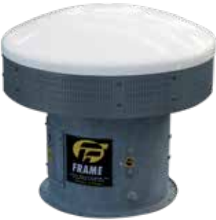
TORXEF504X2 Электрический крышной вытяжной вентилятор 0,75 кВт. Производительность: 8000 м³/ч @ патрубок 5 мм – АТЕХ 22
