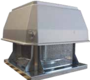
TORX0075G Электрический крышной вытяжной вентилятор 1,5 кВт – Производительность: 7600 м³/ч @ патрубок 10 мм – АТЕХ 22
