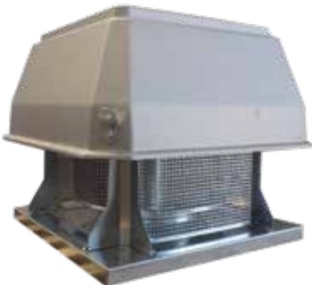
TORX0075G Puissance de 1,5 kW, Volume de 7,600 m³/h @ 10 mm swg – ATEX 22
